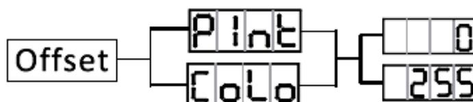
Um das Untermenü für die Einstellung der Anfangsposition zu öffnen, betätigen Sie für mindestens 5 Sekunden die ENTER-Taste. In diesem Untermenü können Sie die Anfangsposition der Schwenkung und die Position des Gaborads einstellen.
